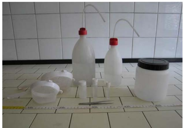
Fig. C 4. Colini, spruzzette, provette, pinzette e barattolo
